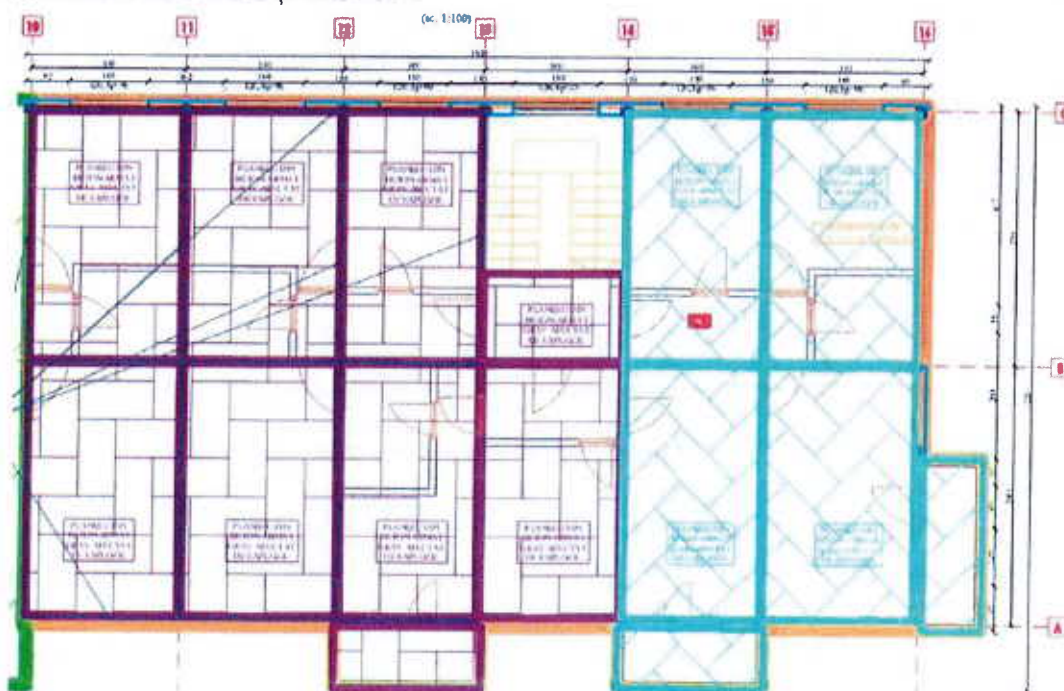
Figura 47 Degradări ale planșeului la cota +2.75m
