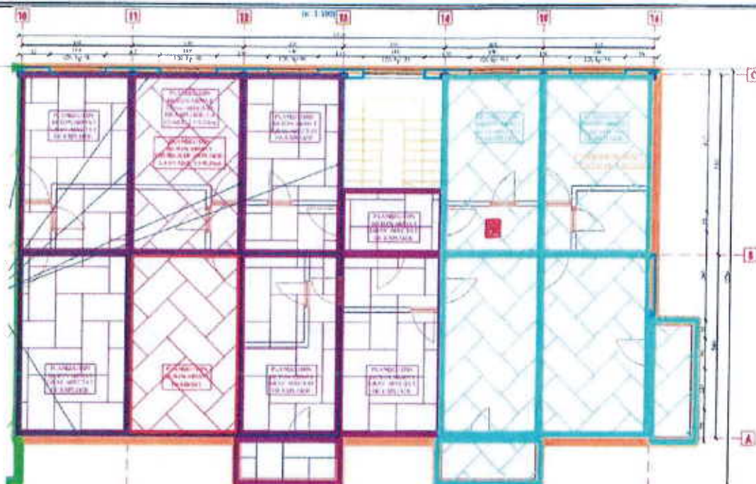
Figura 48 Degradări ale planșelor la cotele +5,55m și +8,35m
