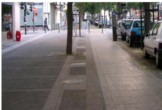
Figura 49 - Dispunerea mobilierului urban și a aliniamentelor de arbori astfel încât să fie eliberat culoarul de deplasare al pietonilor și pentru a crea o zonă de departajare /protecție față de casorabil (sursa: O Stepan)
