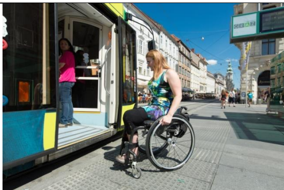
Figura 51 – exemplu de echipare a stațiilor de transport în comun (cu pavaj tactil și panou de afișaj pentru persoanele cu dizabilită și de vedere); autobuze cu podea coborâtă (Graz, Austria) (sursa: www.eltis.org)
