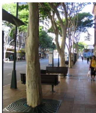
Figura 49 - Dispunerea mobilierului urban și a aliniamentelor de arbori astfel încât să fie eliberat culoarul de deplasare al pietonilor și pentru a crea o zonă de departajare /protecție față de casorabil (sursa: O Stepan)
