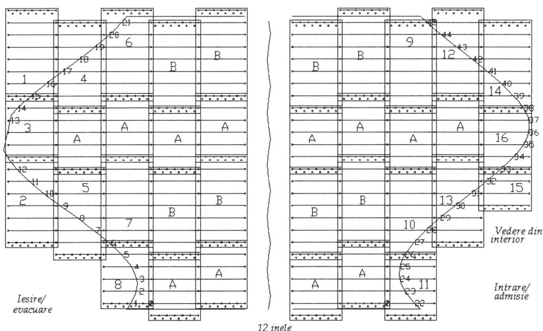
Fig. 3 Schiță de asamblare a structurii din plăci de oțel ondulat
