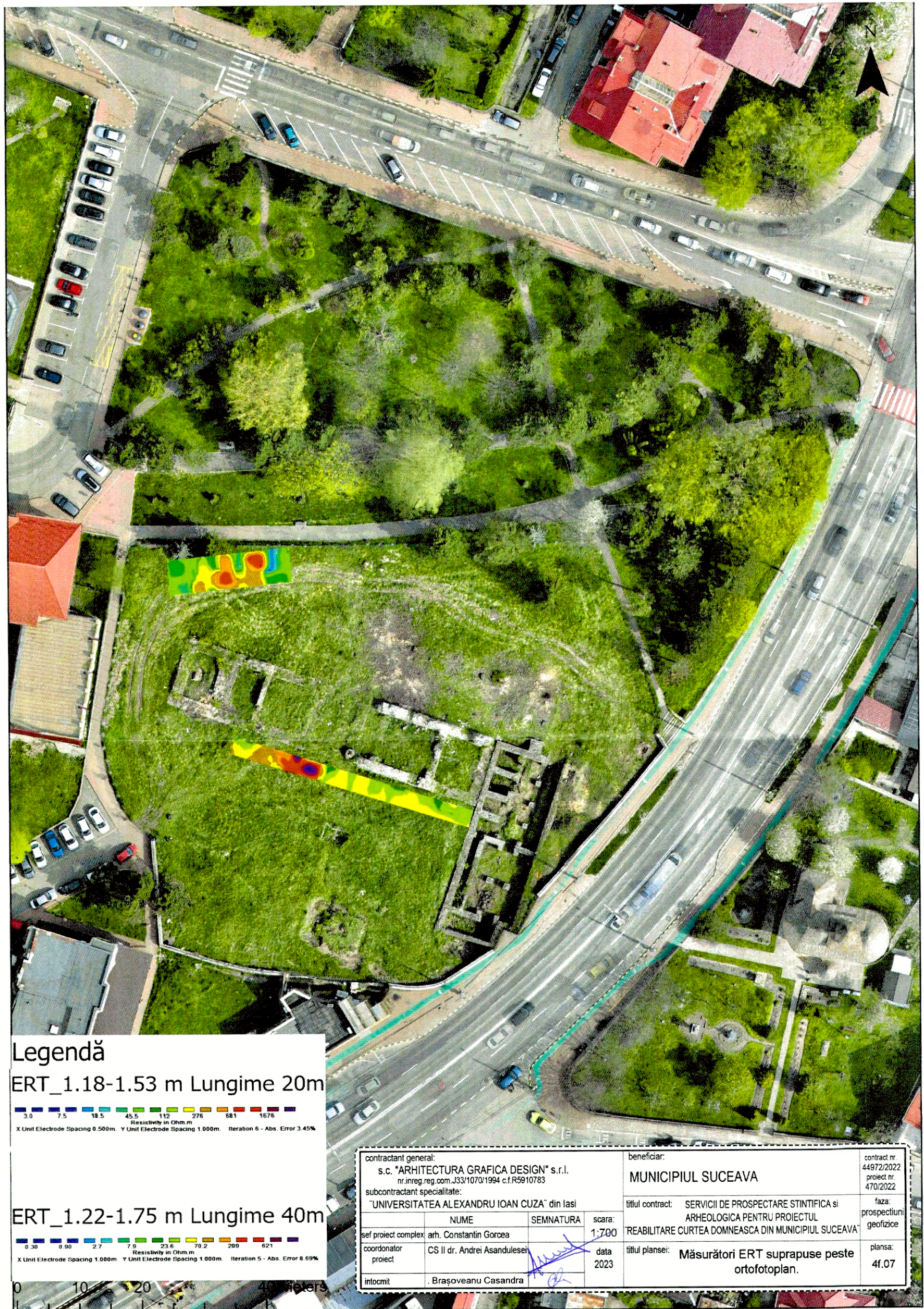
Fig. 7. Măsurători ERT suprapuse peste ortofotoplan.
