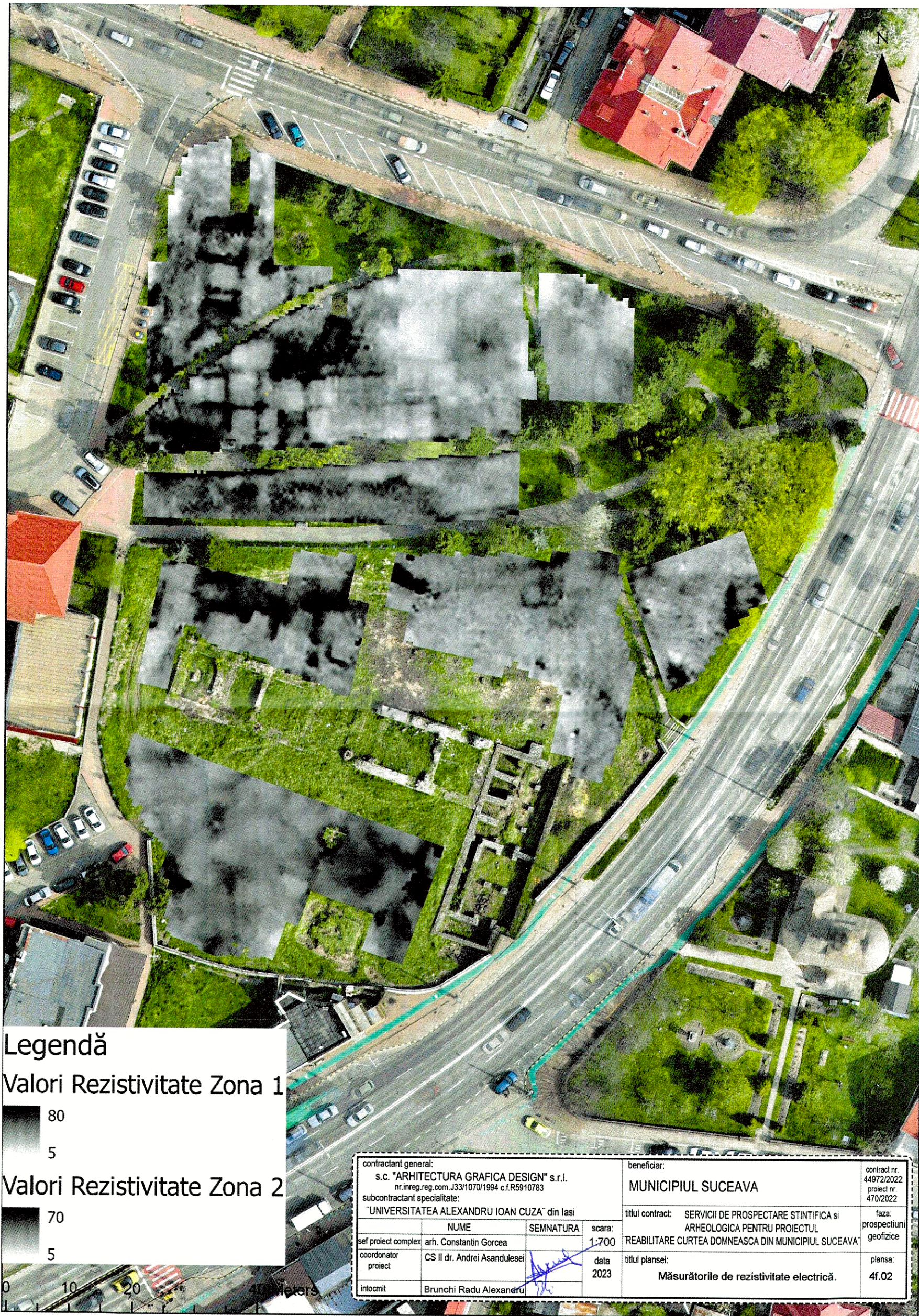
Fig. 2. Măsurătorile de rezistivitate electrică.
