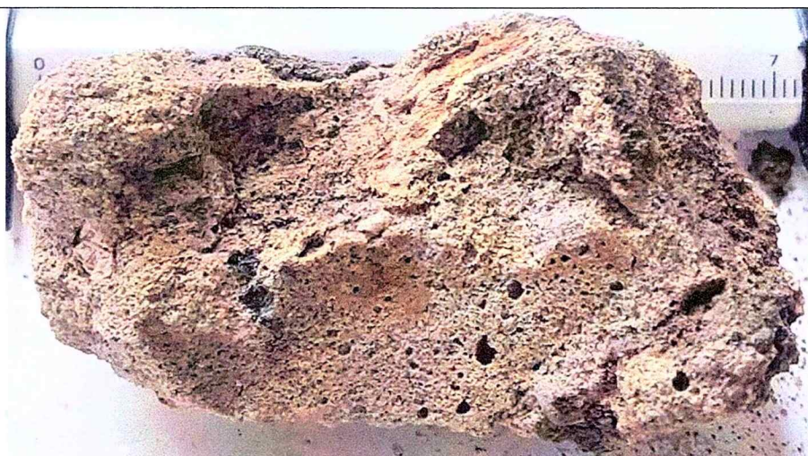
Fig. 34. Imagini macroscopice de detaliu ale probei S8. Se pot vedea componentele structurale ale mortarului: granule de agregat cu dimensiuni contrastante, liant și pori izolați. Local, se observă un fragment de cărămidă de culoare portocalie.
