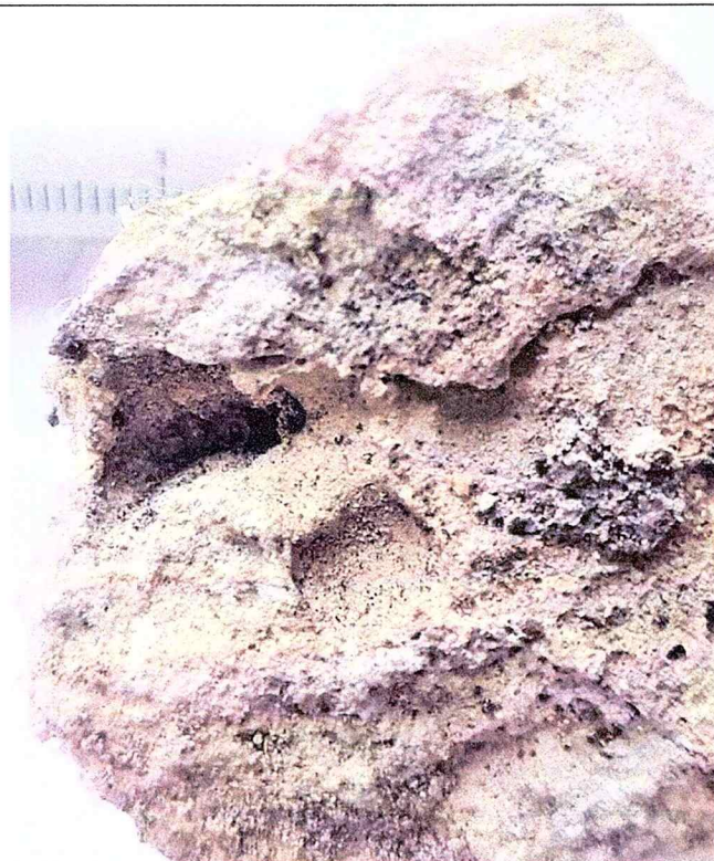
Fig. 43. Imagini macroscopice de detaliu ale unei suprafețe din proba S11. Se observă componentele structurale ale mortarului: rare granule de agregat, liant și pori izolați, sferoidali (secundari).
