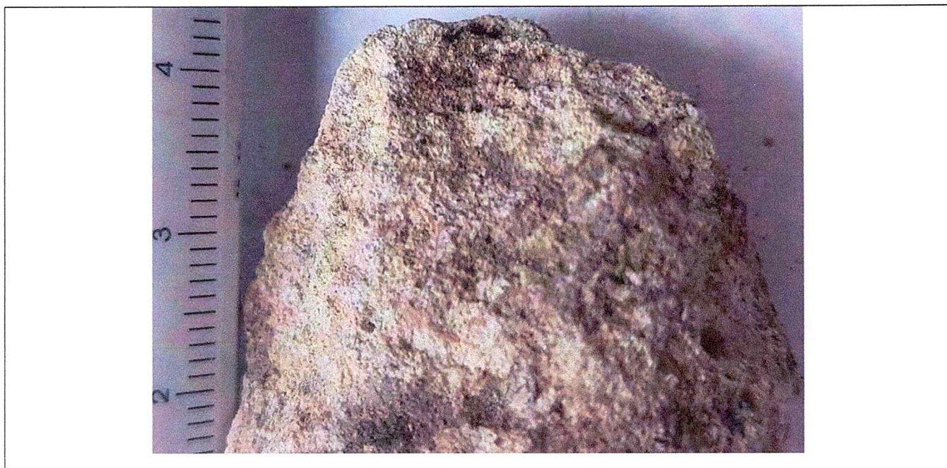
Fig. 12. Imagini macroscopice de detaliu ale probei S3. Suprafețele expuse mediului sunt acoperite parțial cu o crustă cenușie sau albicioasă. Local se pot vedea componentele structurale ale mortarului: granule de agregat, liant și pori izolați.
