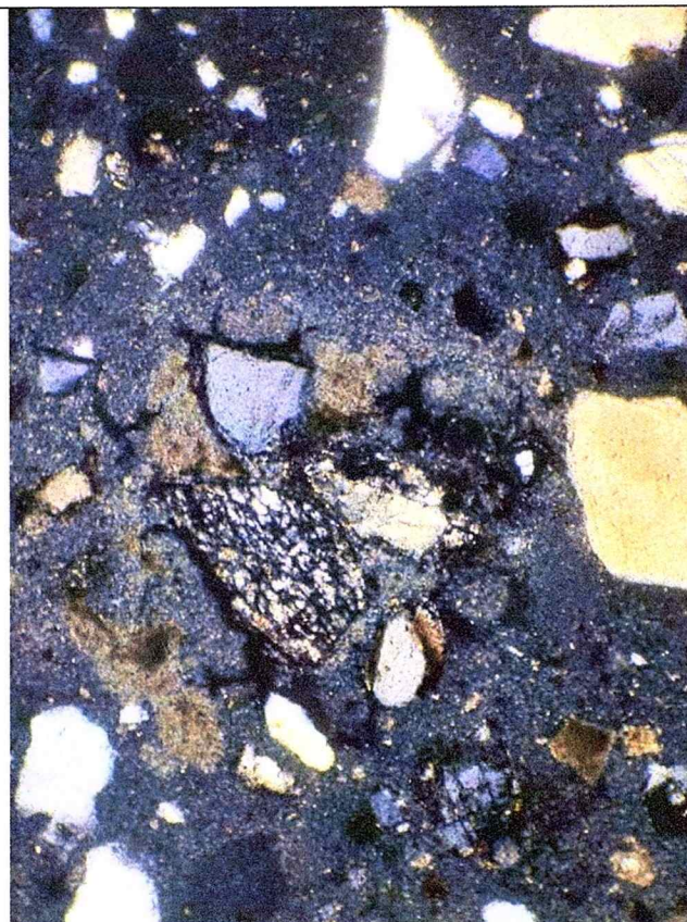
Fig. 25. Imagini microscopice în lumină polarizată, ansamblu și detalii, cu (NII) și (N+) din proba S5. Se observă: (a) agregat din litoclaste de gresie polimictică și filit; granoclaste de cuarț, feldspat, biotit titanifer parțial oxidat, calcit; bulgări de var; "bulgări" de ipsos; (b) liant mixt din calcit criptocristalin, gips criptocristalin, ipsos; (c) pori sferoidali.
