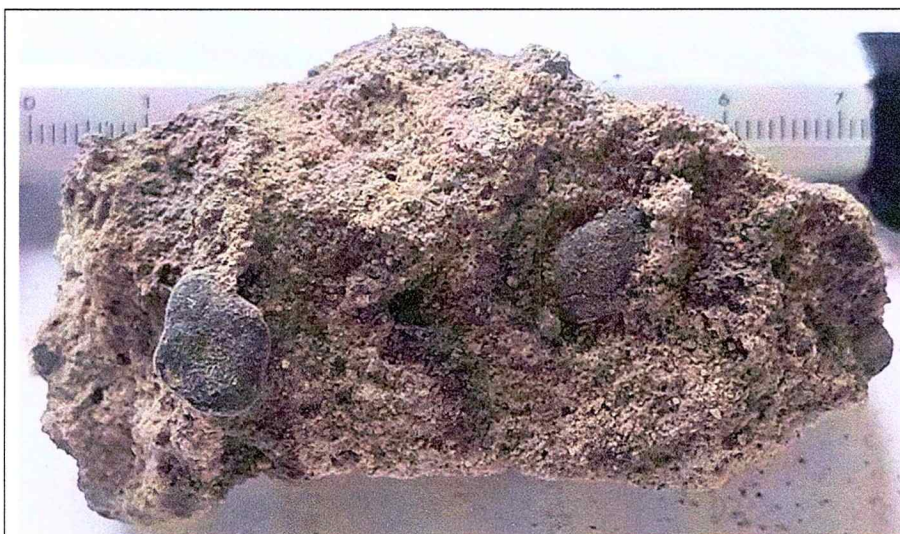
Fig. 34. Imagini macroscopice de detaliu ale probei S8. Se pot vedea componentele structurale ale mortarului: granule de agregat cu dimensiuni contrastante, liant și pori izolați. Local, se observă un fragment de cărămidă de culoare portocalie.
