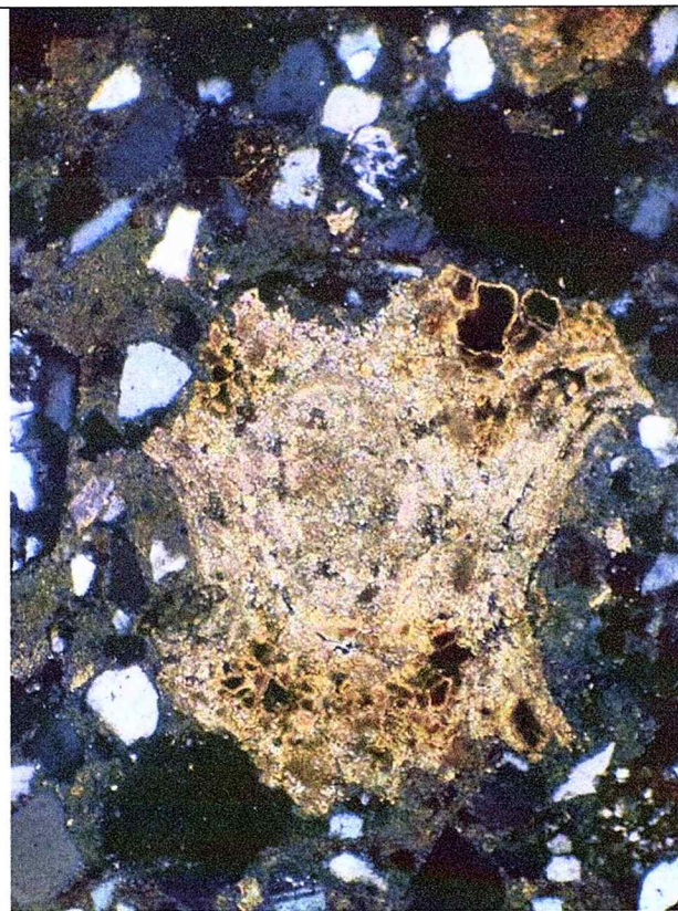
Fig. 59. Imagini microscopice de ansamblu, detaliu și ultra-detaliu, în lumină focalizată, cu (N+) și (NII), din proba S13, pentru a observa, în special, un oolit cu învelișuri concentrice, parțial recristalizat, cu substanță organică de culoare brunie sau negricioasă localizată în învelișurile exterioare.
