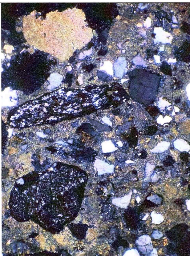
Fig. 35. Imagini microscopice în lumină focalizată, ansamblu și detalii, cu (N+), din proba S8. Se observă: (a) agregat din oolite izolate cu nuclee de cuarțolit și cuarț deformat prin șoc, litoclaste de filit și silicolit, granoclaste de cuarț (unele microfisurate); bulgări de var; (b) liant micro/criptocristalin, local recristalizat; (c) pori de dimensiuni foarte variate, xenomorfi, relativ comunicanți în unele micro-domenii (negri cu N+).
