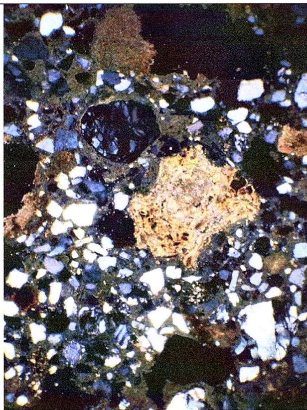
Fig. 59. Imagini microscopice de ansamblu, detaliu și ultra-detaliu, în lumină focalizată, cu (N+) și (NII), din proba S13, pentru a observa, în special, un oolit cu învelișuri concentrice, parțial recristalizat, cu substanță organică de culoare brunie sau negricioasă localizată în învelișurile exterioare.
