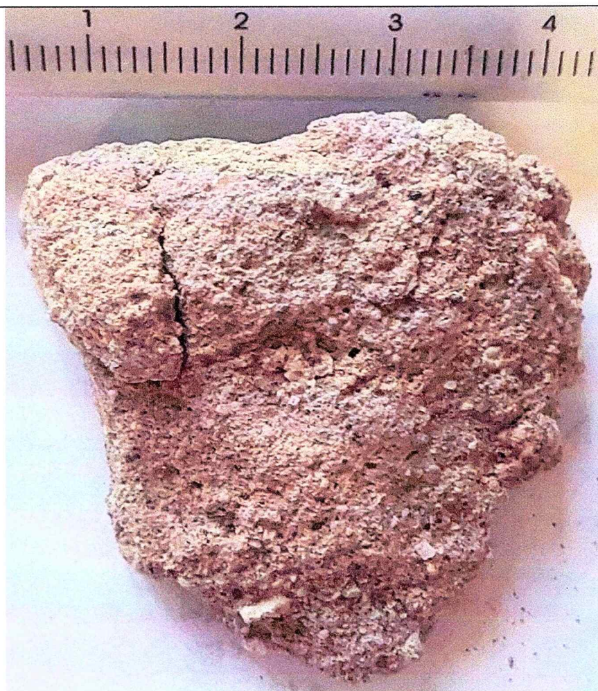
Fig. 62. Imagini macroscopice de detaliu ale probei S14. Se disting componentele structurale ale mortarului: granule de agregat, liant și pori izolați. Un granul de agregat de culoare negricioasă, de circa 3 mm, face notă discordantă.
