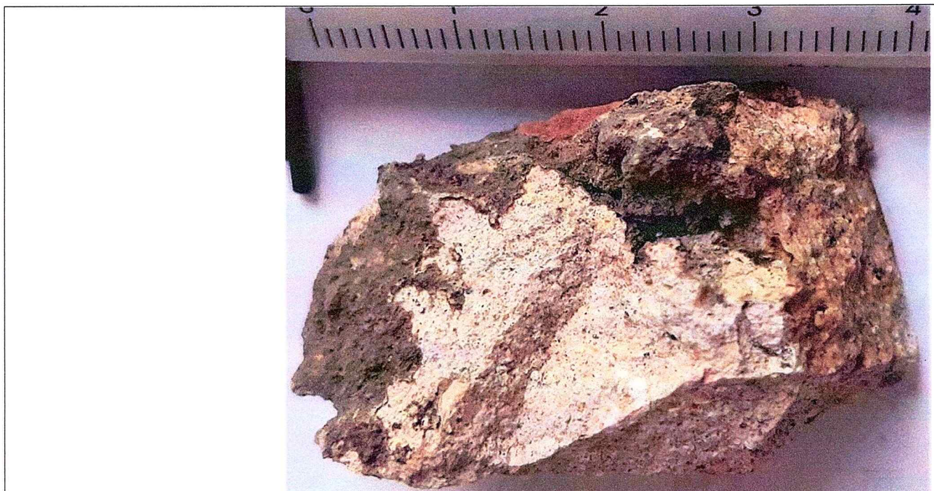
Fig. 18. Imagini macroscopice de detaliu ale probei S4. Fața expusă mediului este acoperită cu o crustă cenușie. Pe intrados se pot vedea componentele structurale ale mortarului: granule de agregat, liant și pori izolați. Local, se observă două fragmente de cărămidă de culoare brună.
