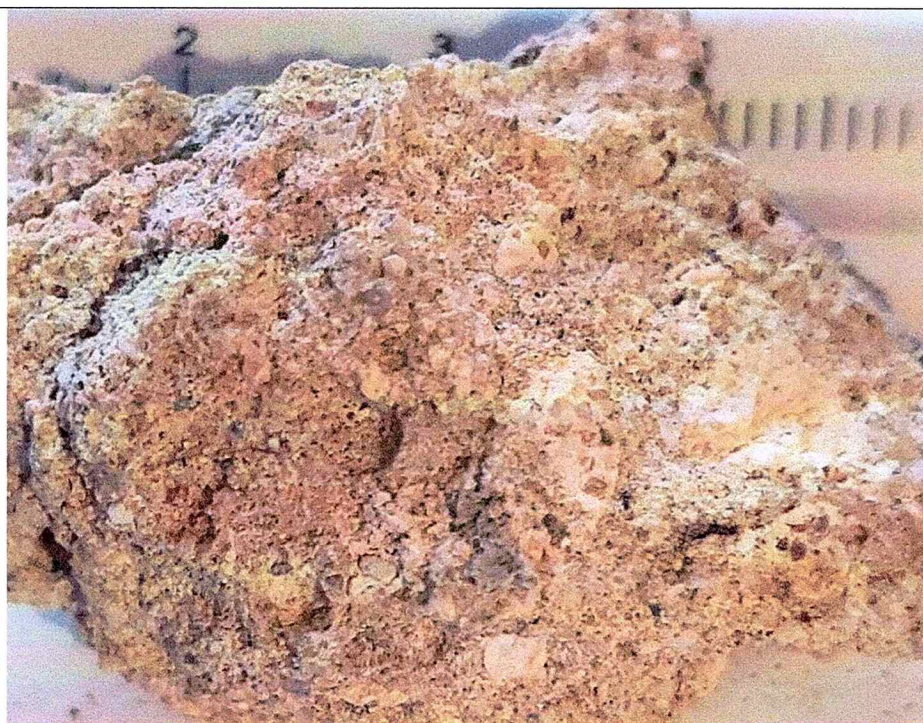
Fig. 57. Imagini macroscopice de detaliu ale altei suprafețe din proba S13, pentru a remarca, în unii bulgări de var, granule de agregat de culoare ocru.
