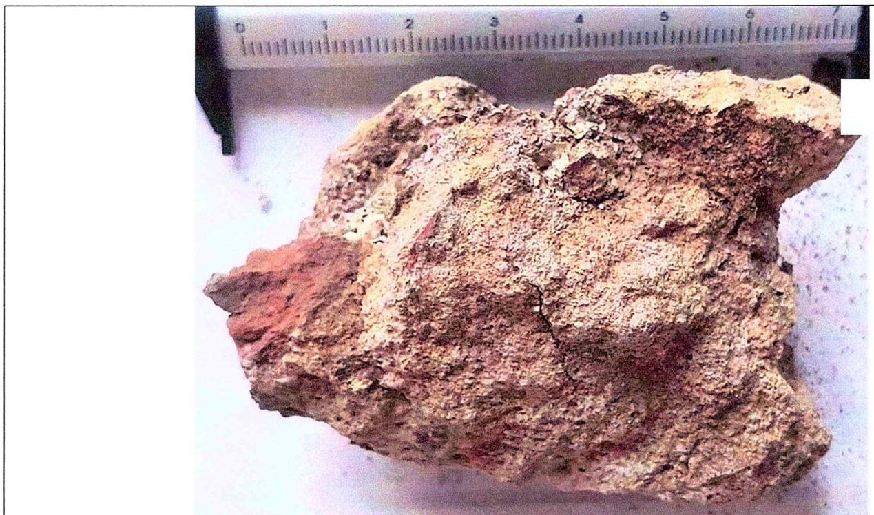
Fig. 28. Imagini macroscopice de detaliu ale probei S6. În mortar se observă fragmentul de cărămidă analizat.
