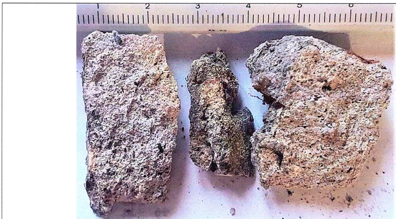
Fig. 72. Imagini macroscopice de detaliu ale eșantioanelor ce compun proba S16. Se pot observa granulele de agregat, liantul cenușiu deschis și pori izolați, mici. Fețele expuse mediului sunt acoperite cu o peliculă cenușie, neuniformă. Într-un eșantion se vede, lateral, un fragment de cărămidă.
