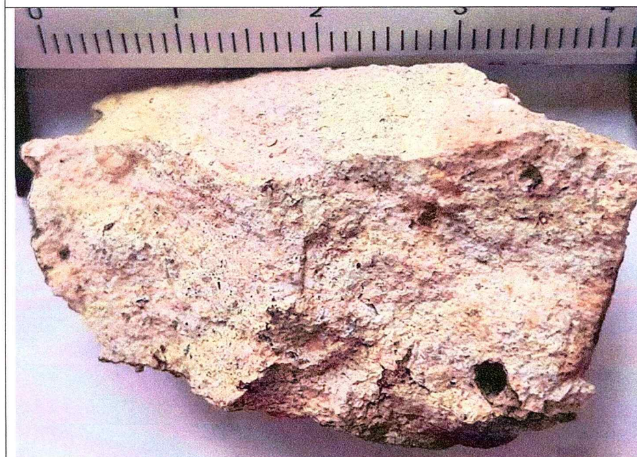
Fig. 18. Imagini macroscopice de detaliu ale probei S4. Fața expusă mediului este acoperită cu o crustă cenușie. Pe intrados se pot vedea componentele structurale ale mortarului: granule de agregat, liant și pori izolați. Local, se observă două fragmente de cărămidă de culoare brună.
