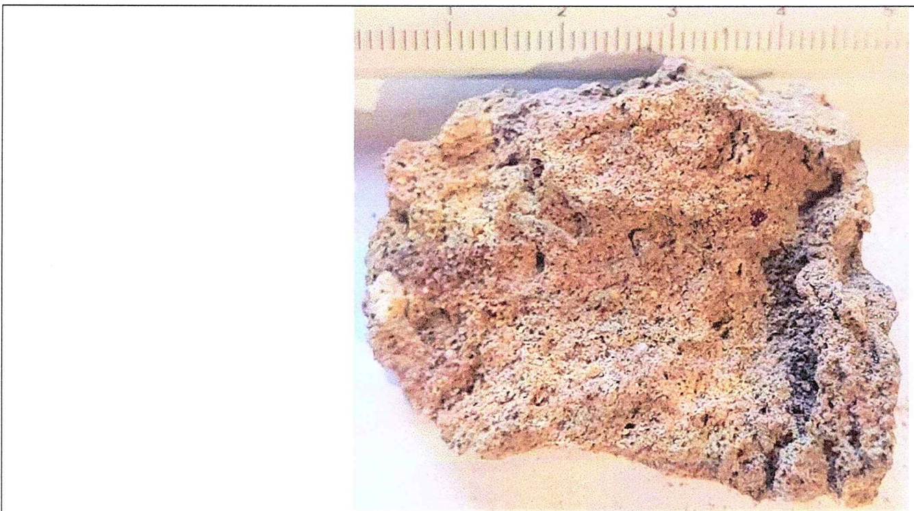
Fig. 51. Imagini macroscopice de detaliu ale probei S12. Zonele expuse mediului sunt acoperite cu o peliculă cenușie.
