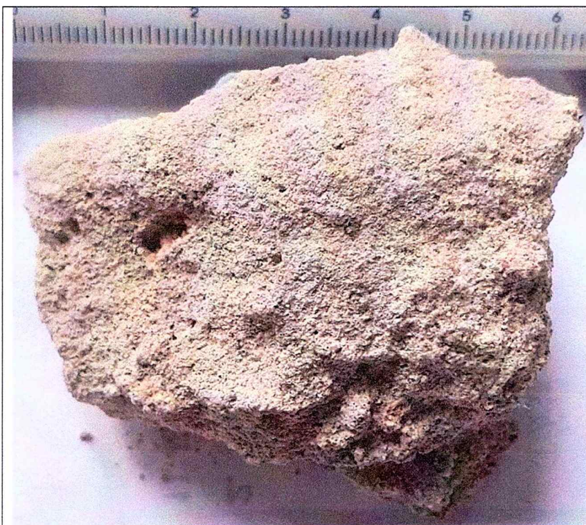
Fig. 82. Imagini macroscopice de detaliu a două suprafețe paralele din proba S9. Se observă componentele structurale ale mortarului: granule de agregat, două de dimensiuni contrastante față de restul; liant și pori izolați, xenomorfi și sferoidali.
