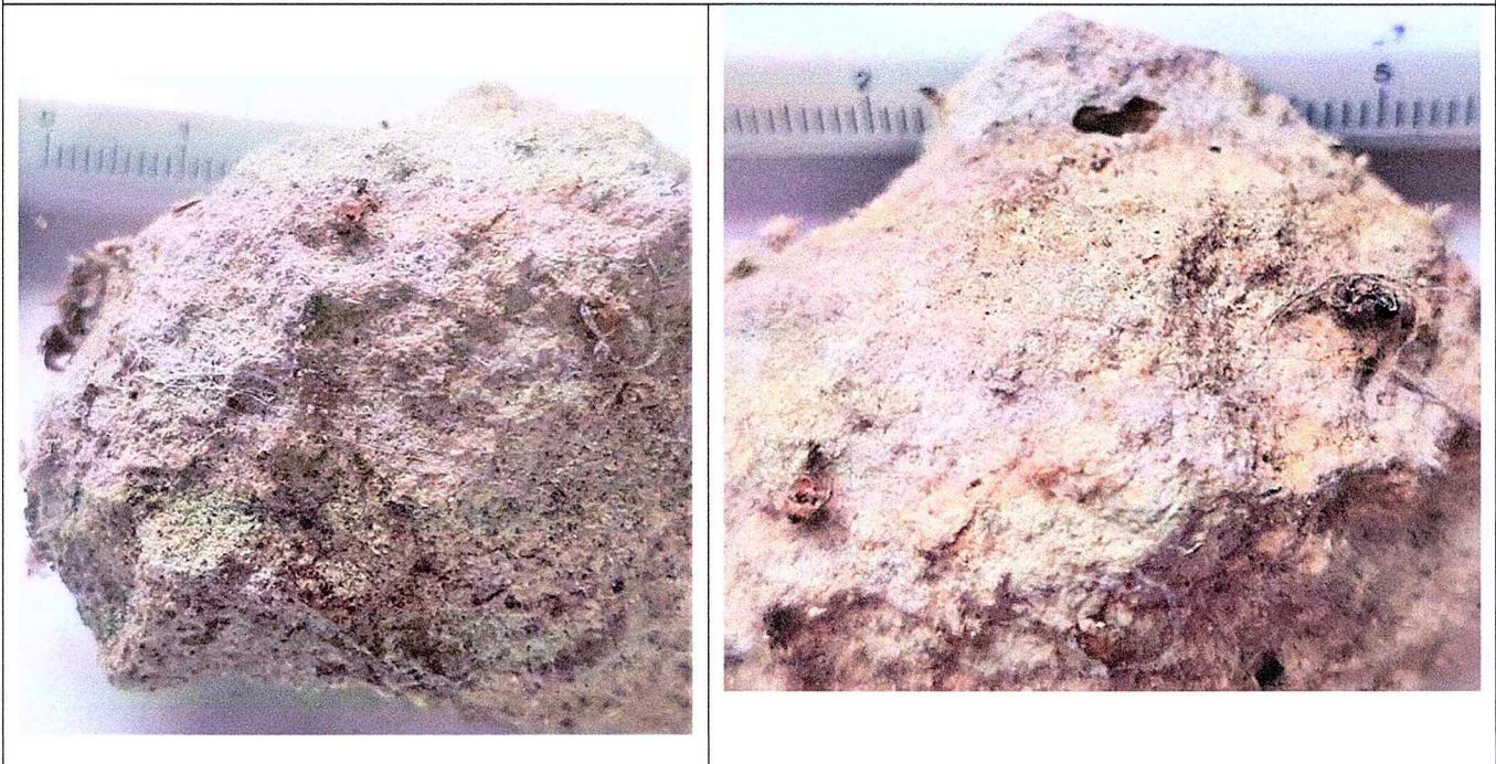
Fig. 44. Imagini macroscopice de detaliu ale altei suprafețe din proba S11, pentru a observa, în plus, fragmente de cărămidă și pori xenomorfi.
