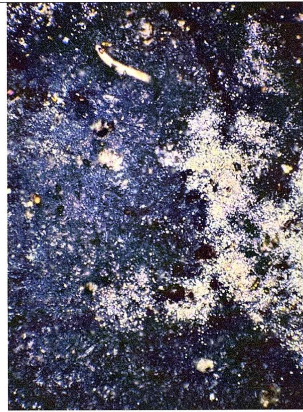
Fig. 79. Imagini microscopice de detaliu și ultra-detaliu, în lumină focalizată, cu (N+) și (NII), din proba S7. Se observă: (a) agregat din litoclast de silicolit, granoclaste de cuarț; (b) un relict de "bulgăre" de ipsos, parțial calcitizat; (c) liant criptocristalin, din gips, ipsos relict și filler calcitic; (d) rari pori izolați, primari-sferoidali și secundari-xenomorfi.
