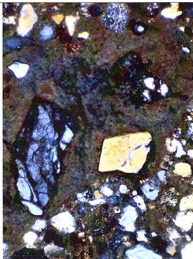
Fig. 35. Imagini microscopice în lumină focalizată, ansamblu și detalii, cu (N+), din proba S8. Se observă: (a) agregat din oolite izolate cu nuclee de cuarțolit și cuarț deformat prin șoc, litoclaste de filit și silicolit, granoclaste de cuarț (unele microfisurate); bulgări de var; (b) liant micro/criptocristalin, local recristalizat; (c) pori de dimensiuni foarte variate, xenomorfi, relativ comunicanți în unele micro-domenii (negri cu N+).
