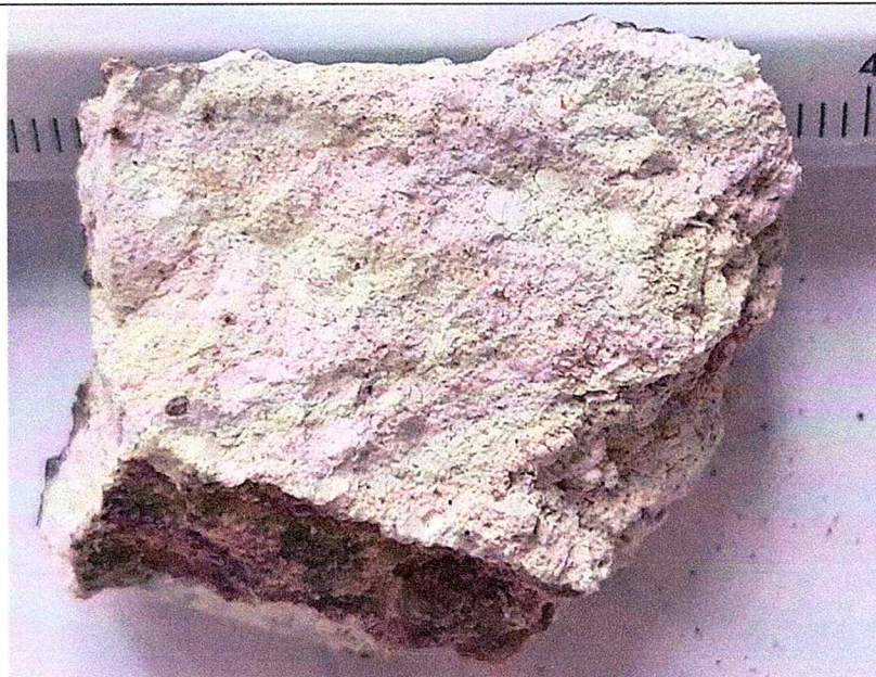
Fig. 23. Imagini macroscopice de detaliu ale probei S5. Se observă componentele structurale ale mortarului: granule de agregat, liant și pori rari, izolați.
