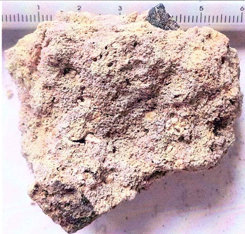
Fig. 82. Imagini macroscopice de detaliu a două suprafețe paralele din proba S9. Se observă componentele structurale ale mortarului: granule de agregat, două de dimensiuni contrastante față de restul; liant și pori izolați, xenomorfi și sferoidali.
