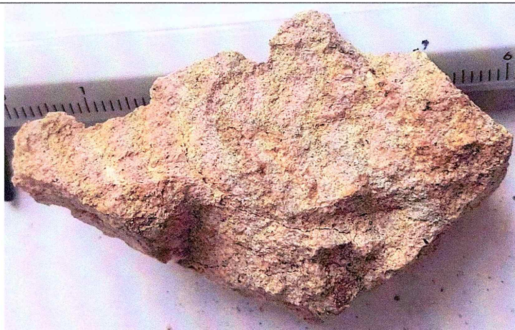
Fig. 38. Imagini macroscopice de detaliu ale probei S10. Se observă componentele structurale ale mortarului: granule de agregat (și un fragment de cărămidă de culoare maronie), liant și pori izolați.
