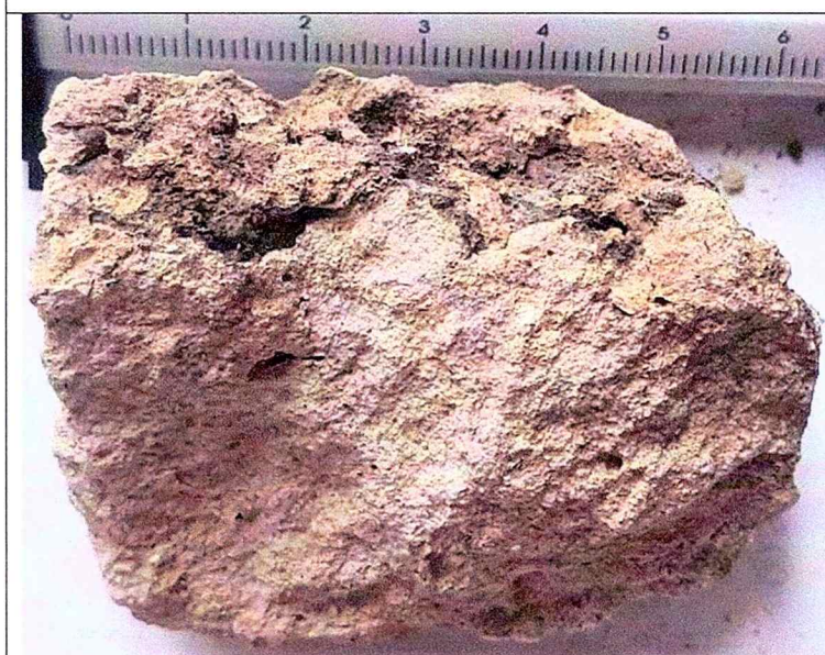
Fig. 8. Imagini macroscopice de detaliu ale probei S2. Se observă componentele structurale ale mortarului: granule de agregat, liant și pori izolați.
