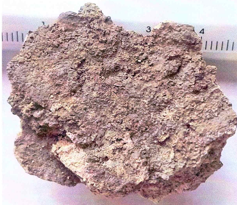
Fig. 3. Imagini macroscopice de detaliu ale probei S1. Fața expusă mediului este acoperită cu o crustă cenușie. Pe intrados se pot vedea componentele structurale ale mortarului: granule de agregat, liant și pori izolați. Local, se observă două fragmente de cărămidă de culoare brună.
