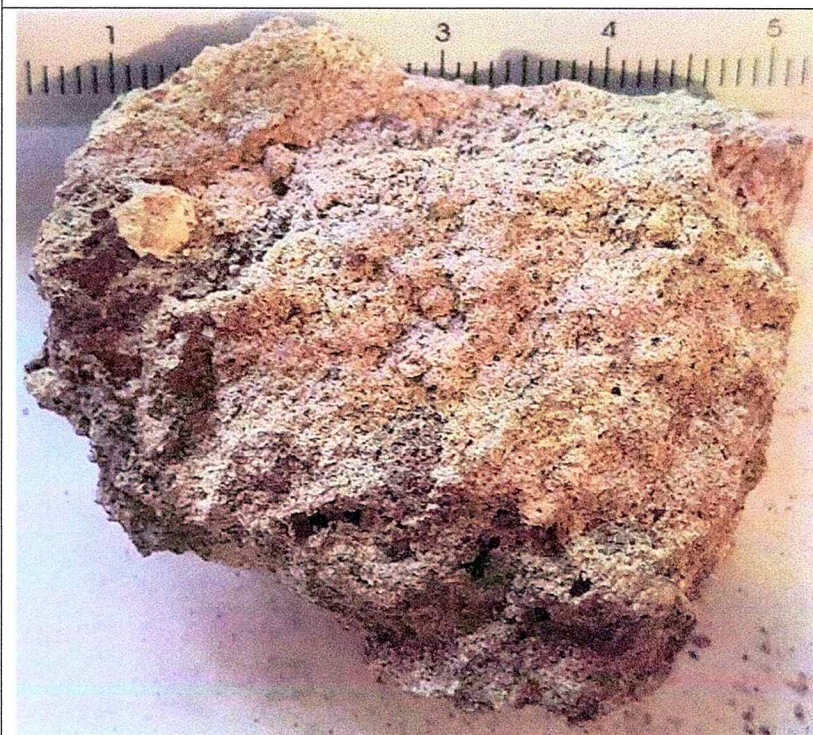
Fig. 51. Imagini macroscopice de detaliu ale probei S12. Zonele expuse mediului sunt acoperite cu o peliculă cenușie.
