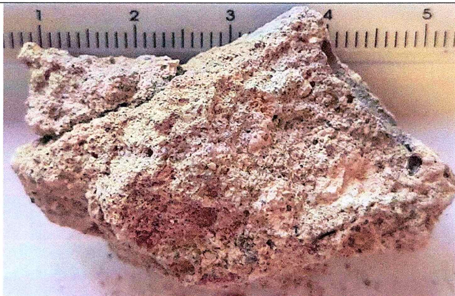
Fig. 57. Imagini macroscopice de detaliu ale altei suprafețe din proba S13, pentru a remarca, în unii bulgări de var, granule de agregat de culoare ocru.
