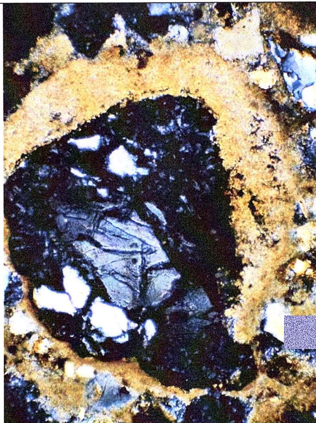
Fig. 35. Imagini microscopice în lumină focalizată, ansamblu și detalii, cu (N+), din proba S8. Se observă: (a) agregat din oolite izolate cu nuclee de cuarțolit și cuarț deformat prin șoc, litoclaste de filit și silicolit, granoclaste de cuarț (unele microfisurate); bulgări de var; (b) liant micro/criptocristalin, local recristalizat; (c) pori de dimensiuni foarte variate, xenomorfi, relativ comunicanți în unele micro-domenii (negri cu N+).
